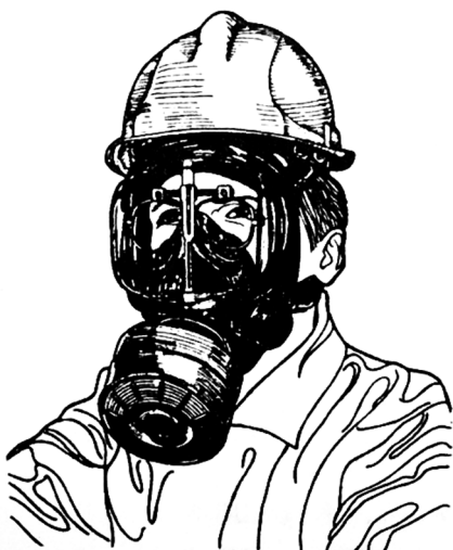
Рис. 8.3. Промышленный противогаз малого габарита ПФМ-1
