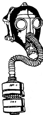
Рис. 8.4. Противогаз ПДФ-2Ш с дополнительным патроном ДПГ-1
